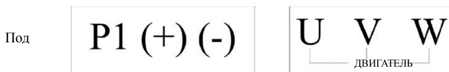
Обозначение контакта трехфазной основной цепи 132 ~ 160 кВт
