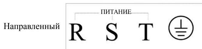
Обозначение контакта трехфазной основной цепи 132 ~ 160 кВт
