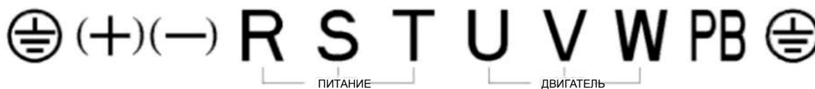
Обозначение контакта трехфазной основной цепи 15 ~ 18,5 кВт
